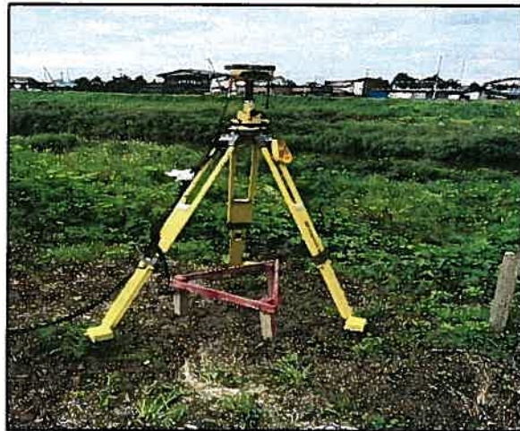
現場基準点上に設置
